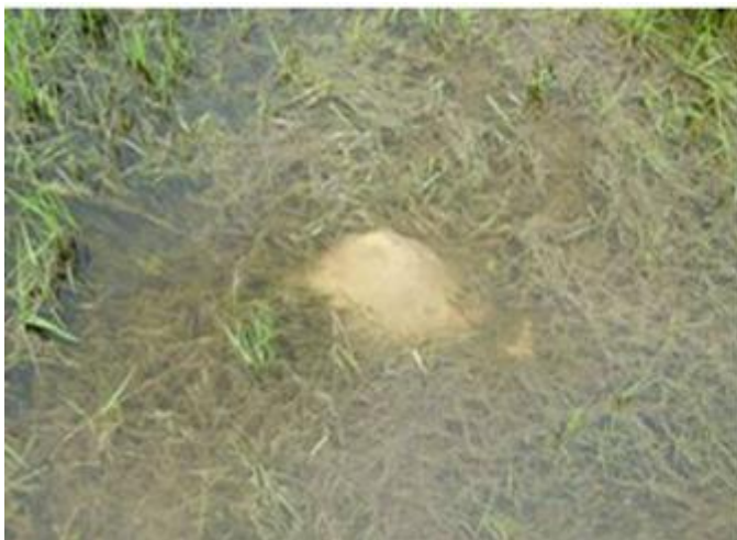
1. sz. kép: Alacsony vízhozamú törpebuzgár
